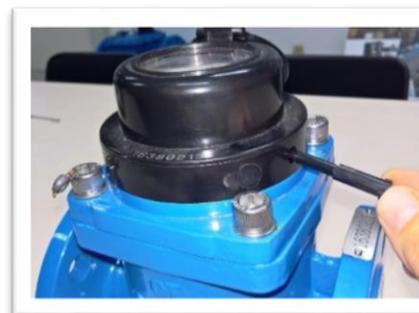
Inserire il supporto cilindrico dell'emettitore di impulsi all'interno del foro visibile sino alla battuta del dispositivo anti sfilamento.
